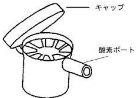
図2 SSV0 スピーキングバルブ 酸素ポート付（底辺内径 15mm）
